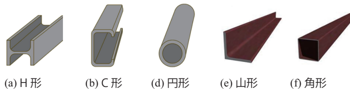
図 6.17 鋼構造の典型的断面形式
