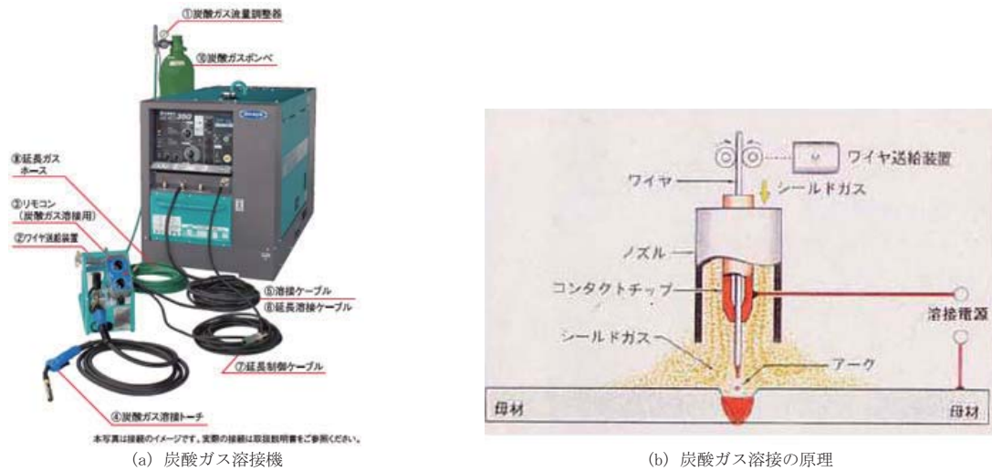
図 9.1 炭酸ガスアーク溶接機とその原理
