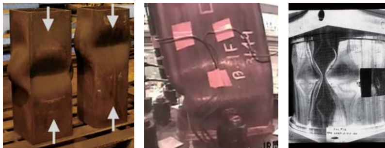
(a) 柱の圧縮局所座屈 (b) 柱の曲げ局所座屈 (c) 円筒の圧縮局所座屈
